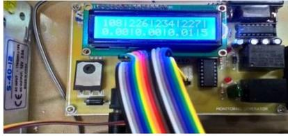
Gambar 4 Pengukuran tegangan batterai
