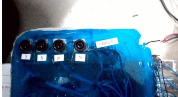
Gambar 5 *input* tegangan rancangan VSD
