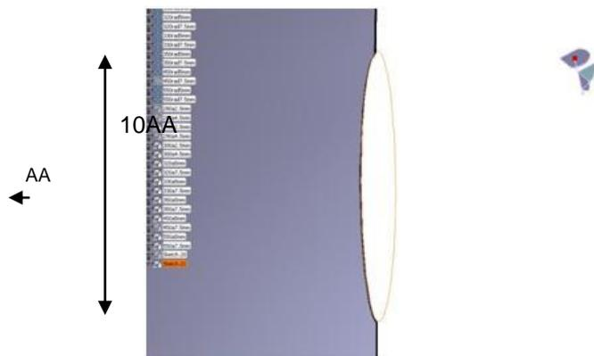
**Gambar 7.** Model 3D dengan *Scallop* untuk ukuran AA= 8mm
