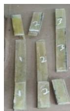
Gambar 6. Hasil Uji Tarik Material Komposit Berpenguat Serat Daun Agel Dengan Pengikat Matrik Polyester Pada Orientasi Arah Serat 0°
