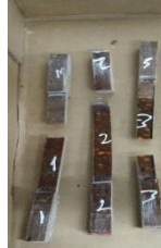
Gambar 5. Hasil Uji Tarik Material Komposit Berpenguat Serat Daun Agel Dengan Pengikat Matrik Epoxy Pada Orientasi Arah Serat 90°
