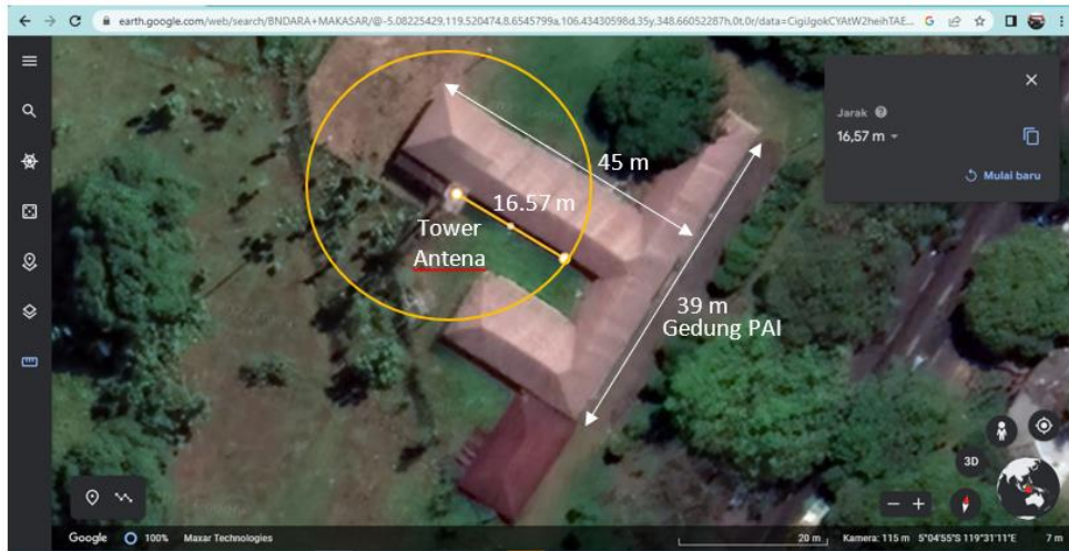
Gambar 4. Sketsa radius penangkal petir konvensional
