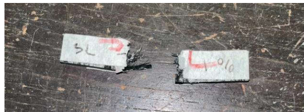
Gambar 12. Uji impact spesimen 3 layer (1%).
