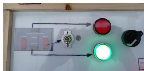
Gambar 12 Toggle Switch Override dan Selektor Switch Hydraulic
