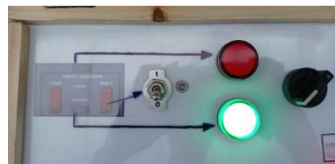
Gambar 12 Toggle Switch Override dan Selektor Switch Hydraulic
