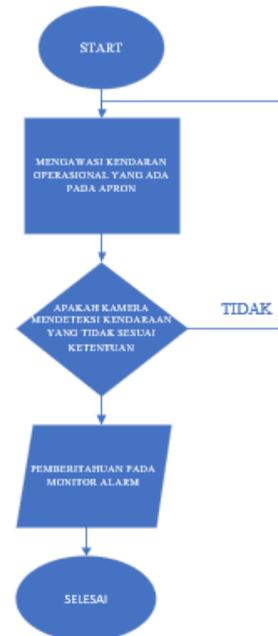
Gambar 2. *Flow chart* system keseluruhan
