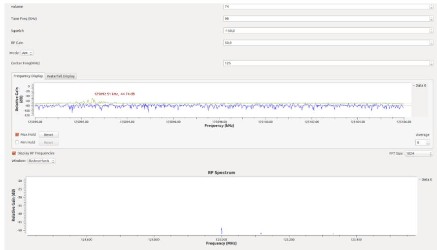
Gambar 10. Penerimaan sinyal pada software GNU Radio
