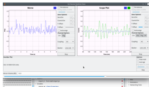
Gambar 6 Hasil Scope GNURadio untuk IDENT dan Perbandingan Phase Reference dan Variable signal (Dokumentasi Penulis, 2020)
