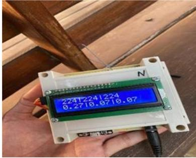
Gambar 4.1 pengujian modul lora sejauh 1,608 M
