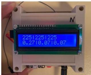
gambar 4.2 pengujian modul lora sejauh 3,167 M
