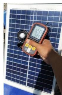
Gambar 10 Pengujian Panel Surya dengan Luxmeter
