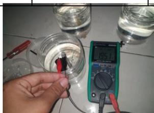
Gambar 4 Pengujian Perbedaan Volume Air
