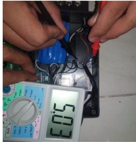
Gambar 7 Pengujian Sensor INA 219
