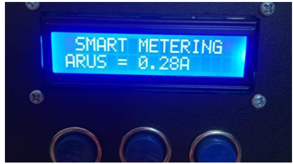
Gambar 6 Tampilan LCD jika tidak terdeteksi pencurian listrik
