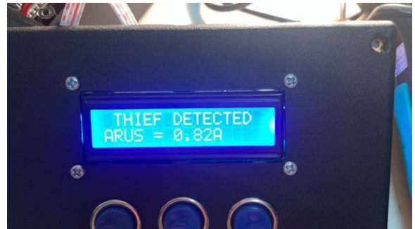
Gambar 7 Tampilan LCD jika terdeteksi pencurian listrik
