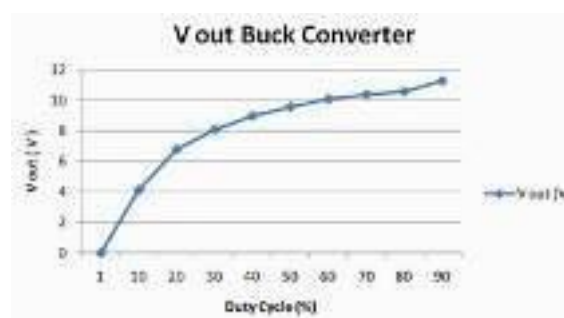
Gambar 3.3. Hasil pengujian buck converter.
