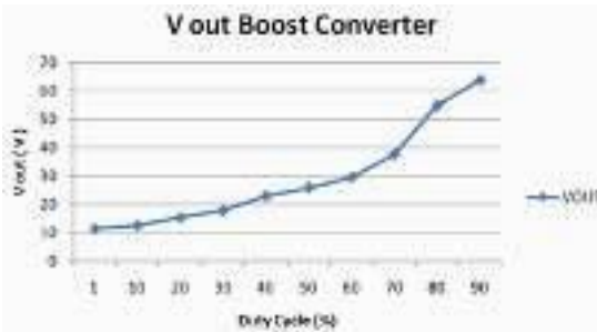
Gambar 3.4. Hasil pengujian boost converter.
