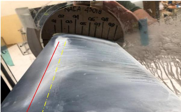
Gambar 7. Airfoil dengan tanpa VG, AoA = 10°
