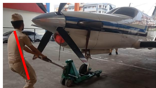
Gambar 8 Modifikasi hand pallet pada TBM 700
