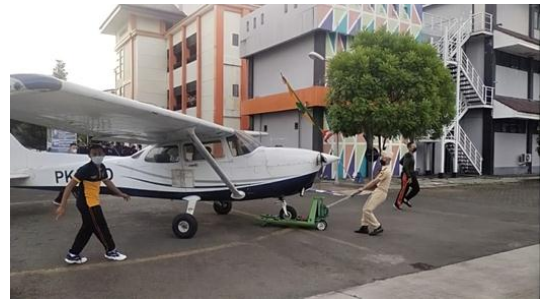
Gambar 11 Proses berbelok dengan modifikasi hand pallet
