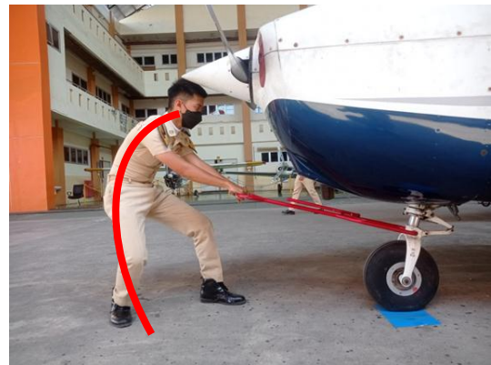
Gambar 7 Postur tubuh towbar lama pada Cessna 172
