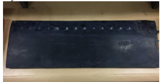
Gambar 2 Profil Airfoil NACA 0012
