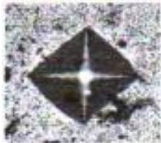
Gambar 9. Jejak Penetrator Pada Suhu 100 °C Selama 50 Menit
