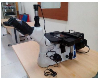
Gambar 4. Alat uji foto struktur mikro dengan kamera Dino Eye Bahan Yang Digunakan
