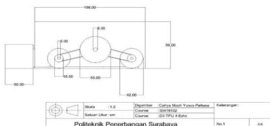
**Gambar 3** Desain Alat Peraga Generator
