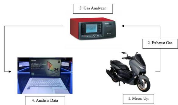
Gambar 9. Skema Pengujian Bahan Bakar Pada Mesin Uji
