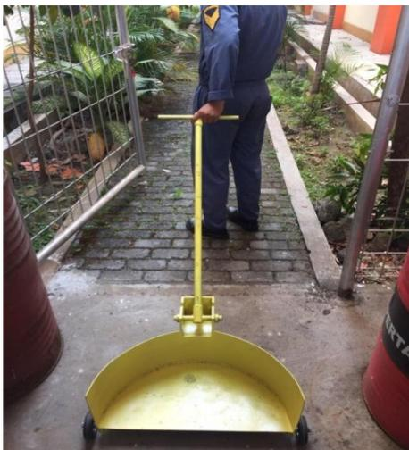
Gambar 6 Bentuk alat trolley drum
