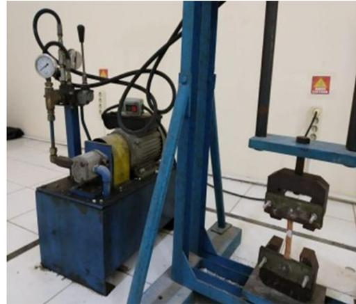
**Gambar 3** Mesin Uji Tarik
