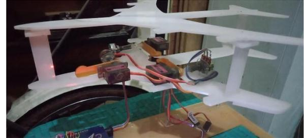
**Gambar 4** Proses Pengujian posisi *Retrack*
