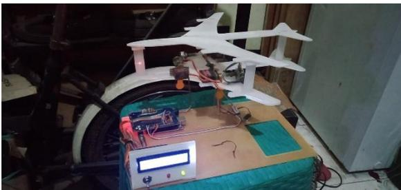
**Gambar 3** Proses Pengujian posisi *Extend*
