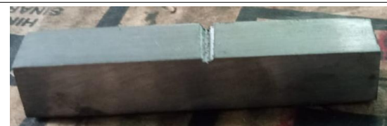
Gambar 2. Konfigurasi spesimen uji impak.
