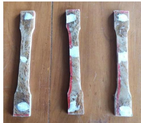
Gambar 2. Spesimen uji tarik dan tarik
