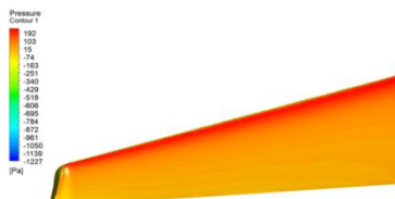
Gambar 8 Kontur sebaran tekanan lower surface airfoil pada sudut serang 19° tanpa winglet
