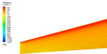
Gambar 8 Kontur sebaran tekanan lower surface airfoil pada sudut serang 19° tanpa winglet
