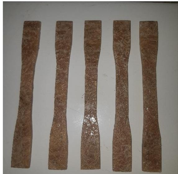
Gambar 4. Spesimen uji tarik
