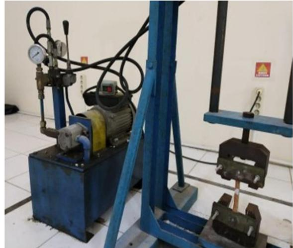
**Gambar 3** Mesin Pengujian Tarik
