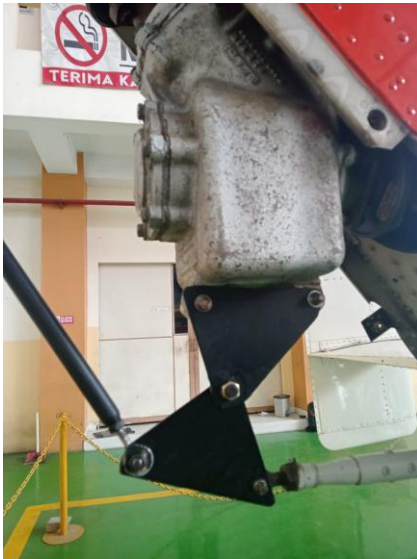
Gambar 2 rancangan bellcrank yang kami buat
