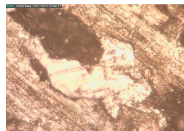
Gambar 5. Struktur Mikro Spesimen Uji pada Suhu 150°C Selama 90 Menit
