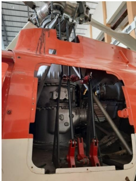
Gambar 5. Rangkaian control rods baru
