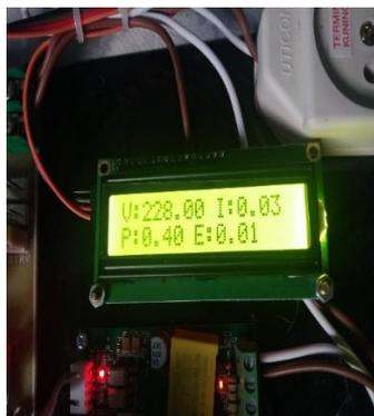
Gambar 4 Pengukuran pada Sesnsor Arus
