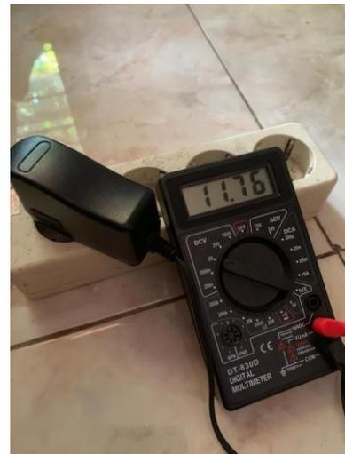
Gambar 3 Pengujian Catu Daya
