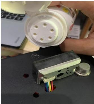
Gambar 6. Pengujian Sensor Debu dengan menggunakan bedak
