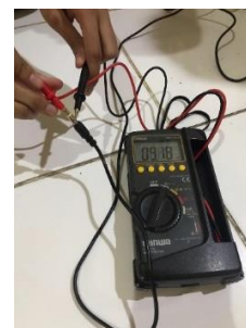
Gambar 2 Pengukuran Power Supply menggunakan AVO
