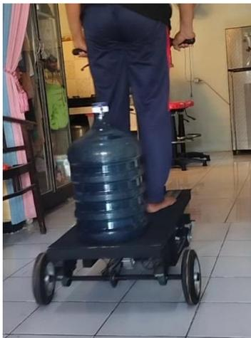
Gambar 7 Pengujian dengan Beban 89 kg
