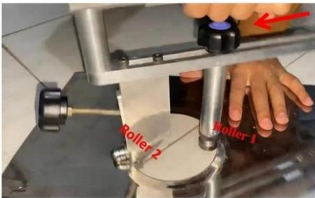
Gambar 4.3. Proses Pengerjaan *Flanging Tools*
