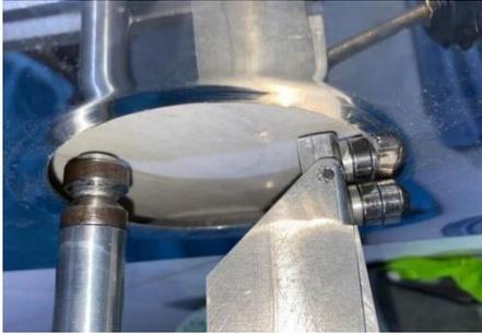
Gambar 4.2. Pemasangan *Flanging Tools* ke *Lightening Hole*
