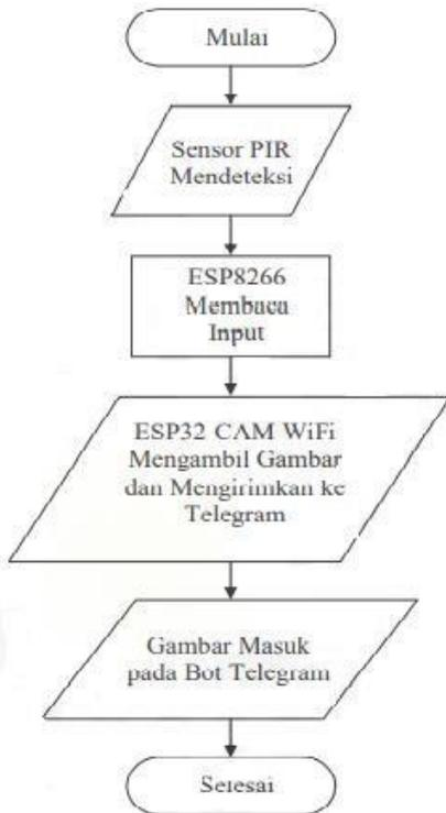
Gambar 2 Flow Chart Perangkat sistem
