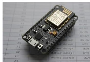
Gambar 3 : NodeMCU ESP8266
