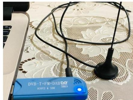
Gambar 8 Menyambungkan RTL-SDR
