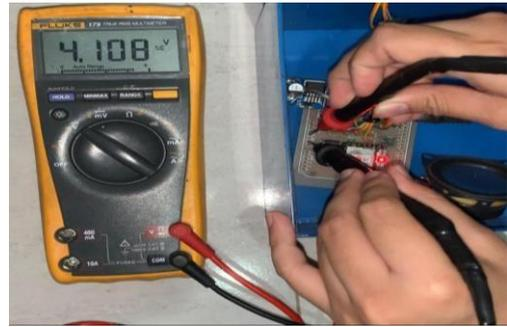
Gambar 7 Pengukuran Input Arduino Uno
