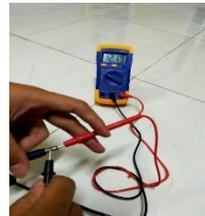
Gambar 2.2 mengukur adaptor dengan avometer
