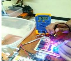
Gambar 2.3 Pengujian tegangan Nodemcu menggunakan avometer
