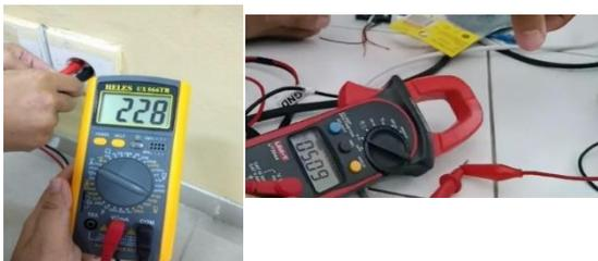
Gambar 3 Pengukuran 228 VAC dan Pengukuran 5,1 VDC
