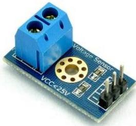
Gambar 3 Sensor Tegangan
