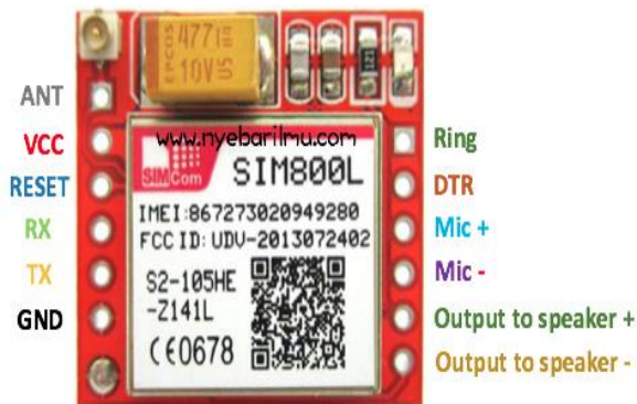
Gambar 8 Modul GSM SIM 800L
