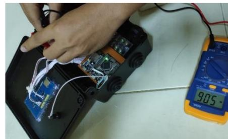
Gambar 5 Pengujian Sensor PZEM 004T
