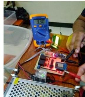
Gambar 6 Pengujian Wemos D1 Mini
