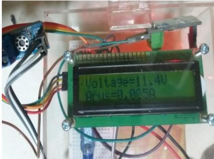
Gambar 4 Pengujian Sensor Tegangan
