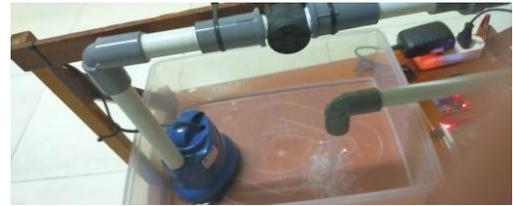
Gambar 6 Pengujian Waterflow Sensor
