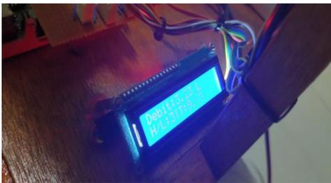
Gambar 5 Rangkaian Modul I2C dan LCD 16X2
