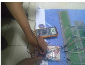
Gambar 8. pengujian mikrokontroler mega2560
