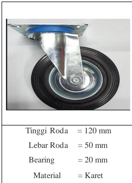
Gambar 1. Spesifikasi Roda
