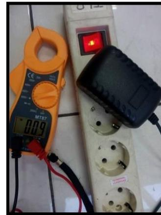
**Gambar 3** Pengujian power suplai
