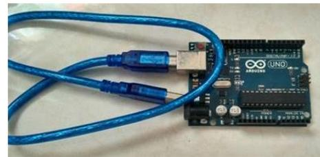
Gambar 14 Arduino UNO ATmega328
