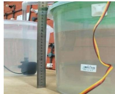
Gambar 19 Mengukur Ketinggian Air Menggunakan Penggaris
