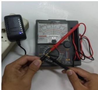
Gambar 13 Pengujian catu daya 5 Vdc
