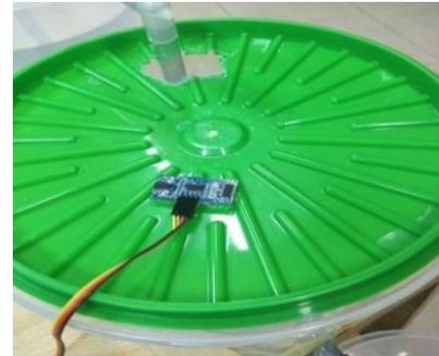
Gambar 18 Mengukur Ketinggian Air Menggunakan Sensor Ultrasonik
